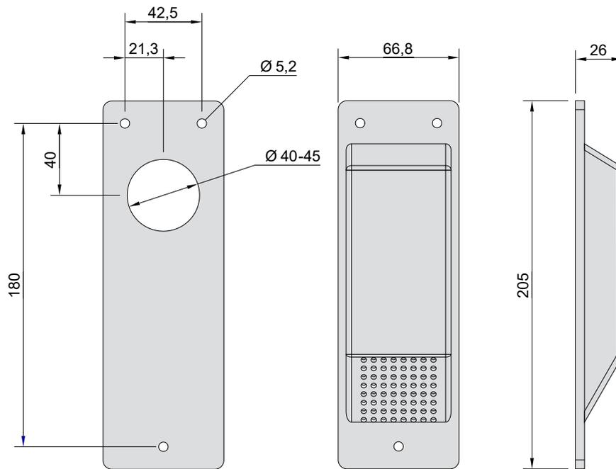
För att full funktion ska uppnås ska verktygslådan ha 2 st luftventiler. En luftventil ska vara monterad högt upp i verktygslådan där varm och fuktig luft evakueras ut. Den andra luftventilen ska vara monterad i den nedre halvan av verktygslådan, gärna diagonalt mot den övre och fungerar som luftintag.
